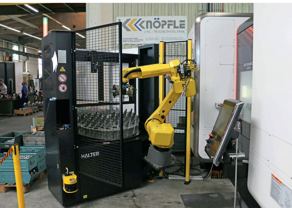
1 Das Gespann aus Integrex-Maschine von Mazak und Halter-Roboter produziert bei Knöpfle Bauteile rund um die Uhr © Henrich/Ehm
