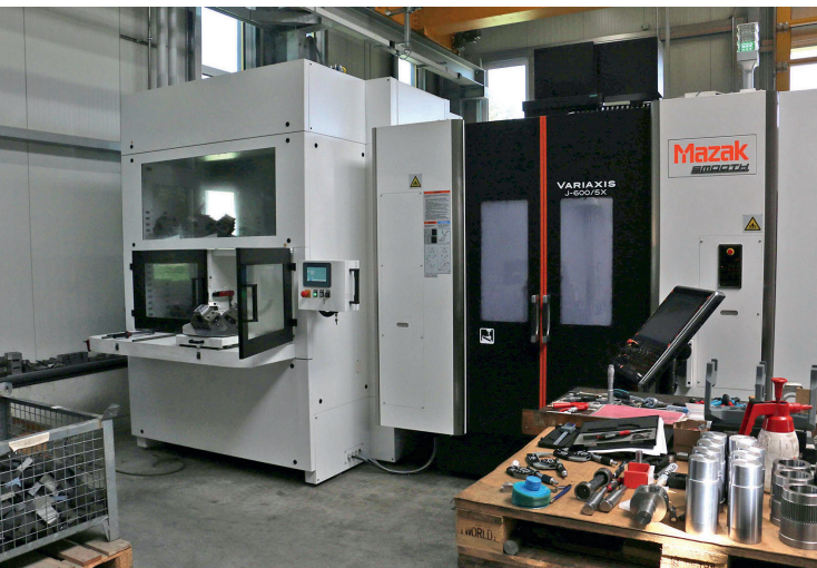
4 Die Variaxis-Maschine von Mazak ist bei Knöpfle mit einem Palettsystem automatisiert © Henrich/Ehm
